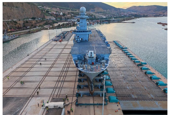
Figura 10 – Sistema synchrolift em operação
